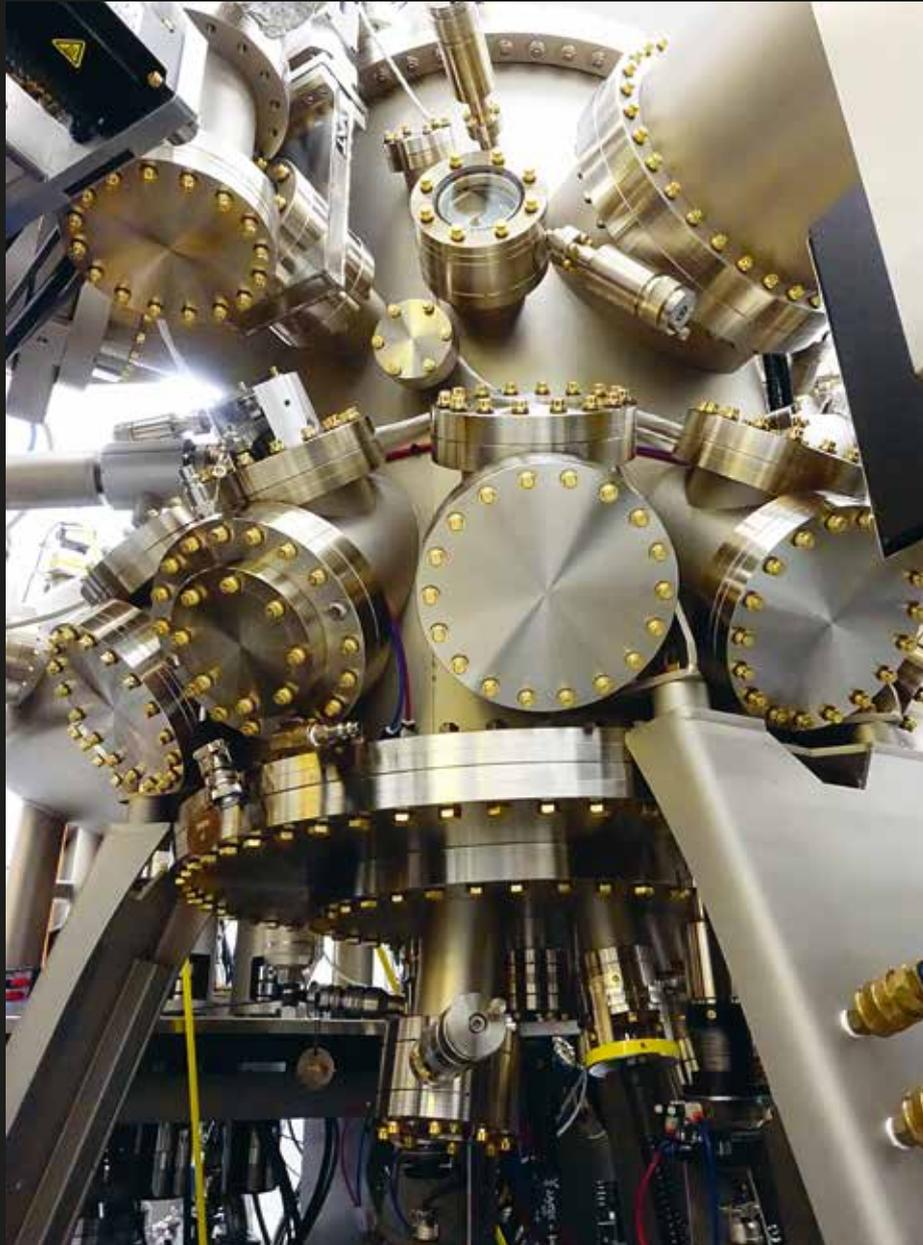
Mit diesem vier mal drei Meter messenden, 2,7 Tonnen schweren Koloss versiegeln die Forscher reiskorngroße Objekte. Die Molekularstrahlepitaxie-Anlage des Ferdinand-Braun-Instituts, Leibniz-Institut für Höchstfrequenztechnik stellt so sicher, dass die winzigen Laserdioden extrem viel Lichtleistung liefern — ohne kaputtzugehen. Denn sie kommen nicht nur in der Medizin, sondern auch auf Satelliten im Weltraum zum Einsatz.
